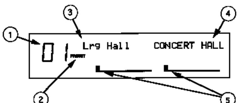
сигнал отсутствует. Обычно индикаторы помечены символами "L" и "R". Однако, если программа использует конфигурацию типа Dual (два моно эффекта), индикаторы помечаются символами "CH1" и "CH2". Более подробная информация о конфигурации типа Dual приведена в главе 3.
