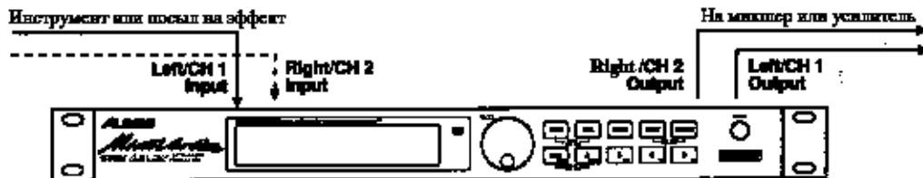
При коммутации MidiVerb 4 с дополнительными посылами/возвратами микшерной консоли, вам может потребоваться установить выходной сигнал на максимум эффекта (в выходном миксе прибора присутствует только обработанный сигнал). Это делается с помощью соответствующей глобальной опции, устанавливающей этот режим одновременно для всех программ (см. раздел Управление миксом прямого и обработанного сигналов).
