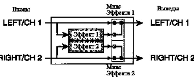
В этом случае выходной сигнал с эффекта 1 подается на вход эффекта 2. Управление каскадным режимом проводится со страницы 2 режима Utility (см. главу 5). В каскадном режиме с левого выхода [LEFT/CH.1 OUTPUT] снимается сигнал, обработанный только первым эффектом, в то время как с правого выхода [RIGHT/CH.2 OUTPUT] — сигнал, прошедший через оба эффекта.
