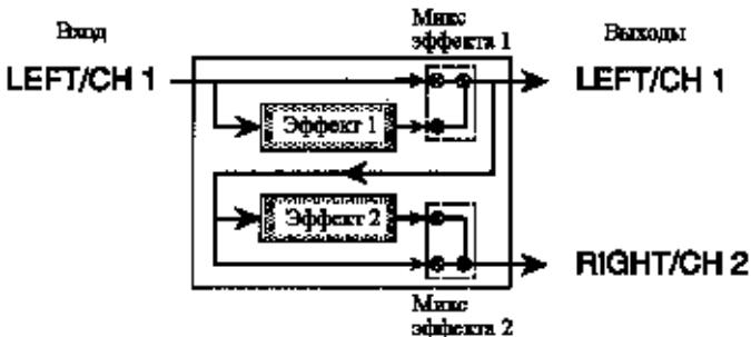
Замечание. В каскадном режиме вход [RIGHT/CH.2 INPUT] недоступен, поскольку на него подается сигнал с выходного канала первого эффекта.
