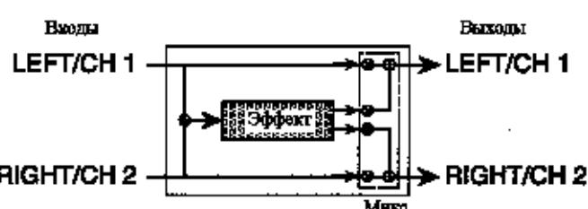
В каждом из перечисленных выше случаев прямой сигнал с обоих входов передается на выходы.
