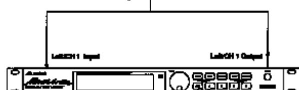
(монофонические джеки) MidiVerb 4. С помощью другого 1/4" TRS Y-кабеля скоммутируйте разрыв пульта другого канала (стереофонический джек) с правым входом ([RIGHT/CH.1 INPUT]) и выходом ([RIGHT/CH.2 OUTPUT]) (монофонические джеки) MidiVerb 4. Такая схема позволяет организовать независимую обработку двух каналов, поскольку каждый из них обрабатывается своим эффектом.
