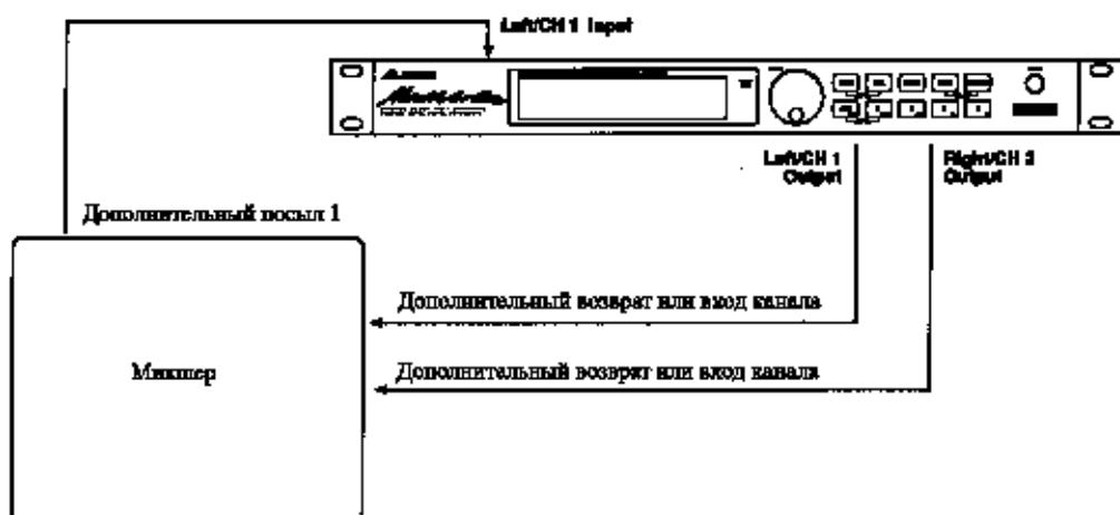
проводом с одним гнездом возврата с эффекта, а правый выход ([RIGHT/CH.2 OUTPUT]) — с другим (или с входным каналом микшера).
