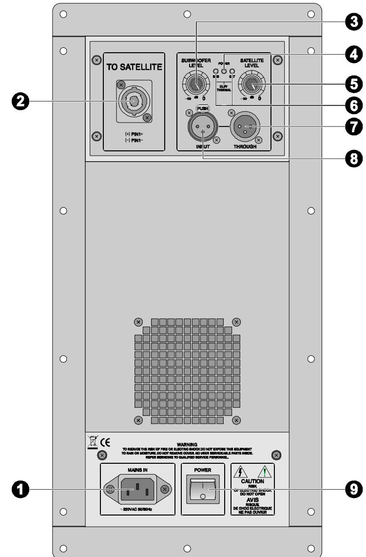
**① MAINS IN** – соединитель для подключения сетевого кабеля.
