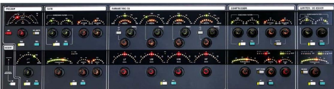
соответствующим изменением кривой. Доступные к изменению контроллеры оборудованы светодиодами, загорающими при возможном изменении параметра. Например, модуль Gate не используется на каналах выхода, соответственно индикаторы светиться не будут.
