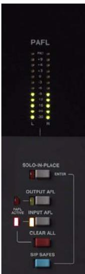
Система iLive оборудована гибкой системой мониторинга, позволяющей прослушивать сигнал в различных участках цепи его прохождения. Обычная Пре-Фейдерная система расширена, позволяя оператору прослушивать каналы входов или миксов до или после фейдера при помощи переключателей находящихся в правой части консоли под индикатором уровня сигнала.
