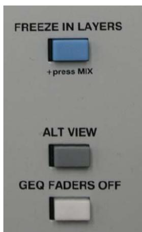
Функция **FREEZE IN LAYERS**, в сочетании с кнопкой **MIX** позволяет “замораживать” в слоях выбранные каналы. Для отмены “заморозки” применяется тоже сочетание кнопок. Для перманентной “заморозки” применяется назначение на все слои в меню SURFACE SETUP.
